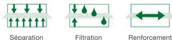
**TECNOGEO P** placé entre la sous-couche et l'élément de fondation ou entre la sous-couche et la couche drainante répond à ses fonctions de séparation et de filtration.
