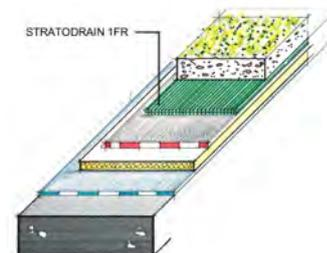
Dans les toitures végétalisées, le Stratodrain est intercalé entre les couches de membranes d'étanchéité et les couches du terrain. Ainsi, il protège l'étanchéité, draine l'eau excédentaire et maintient l'humidité nécessaire au bon développement et à la pérennité de la végétalisation.
