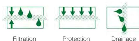
Le géocomposite **STRATODRAIN** remplit les fonctions de filtration, de drainage et de protection des systèmes d'étanchéités.
