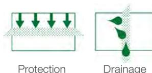
Le **NOPPENMATTE PREMIUM** peut être utilisé comme couche de séparation de matériaux à granulométries différentes et comme protection des étanchéités où l'on ne se trouve pas en présence de sollicitations mécaniques agressives.
