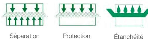
L'association des 2 matériaux confère au composite **PAVISTOP-R** une excellente résistance à la déchirure et au poinçonnement ainsi qu'une barrière efficace contre la pénétration des racines.
