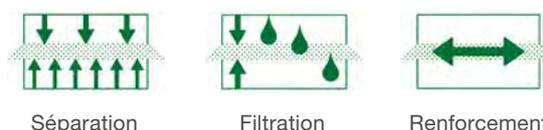
**TECNOGEO TP** placé entre la sous-couche et l'élément de fondation ou entre la sous-couche et la couche drainante répond à ses fonctions de séparation et de filtration.
