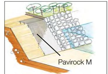
**Pavirock M** wird als Schicht bei Straßenaufbauten und unter den Bahntrassen sowie im Erdbau verwendet und eignet sich außerdem als seitliche Randfilterschicht im Wasserbau.
