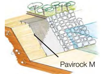
Le géotissé **PAVIROCK M** peut être utilisé dans les constructions routières et ferroviaires ainsi que dans les renforcements de talus en terre. Il est également utilisé comme couche de filtration dans des ouvrages hydrauliques.
